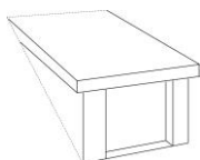
Lucarne à un pan de toit soulevé
